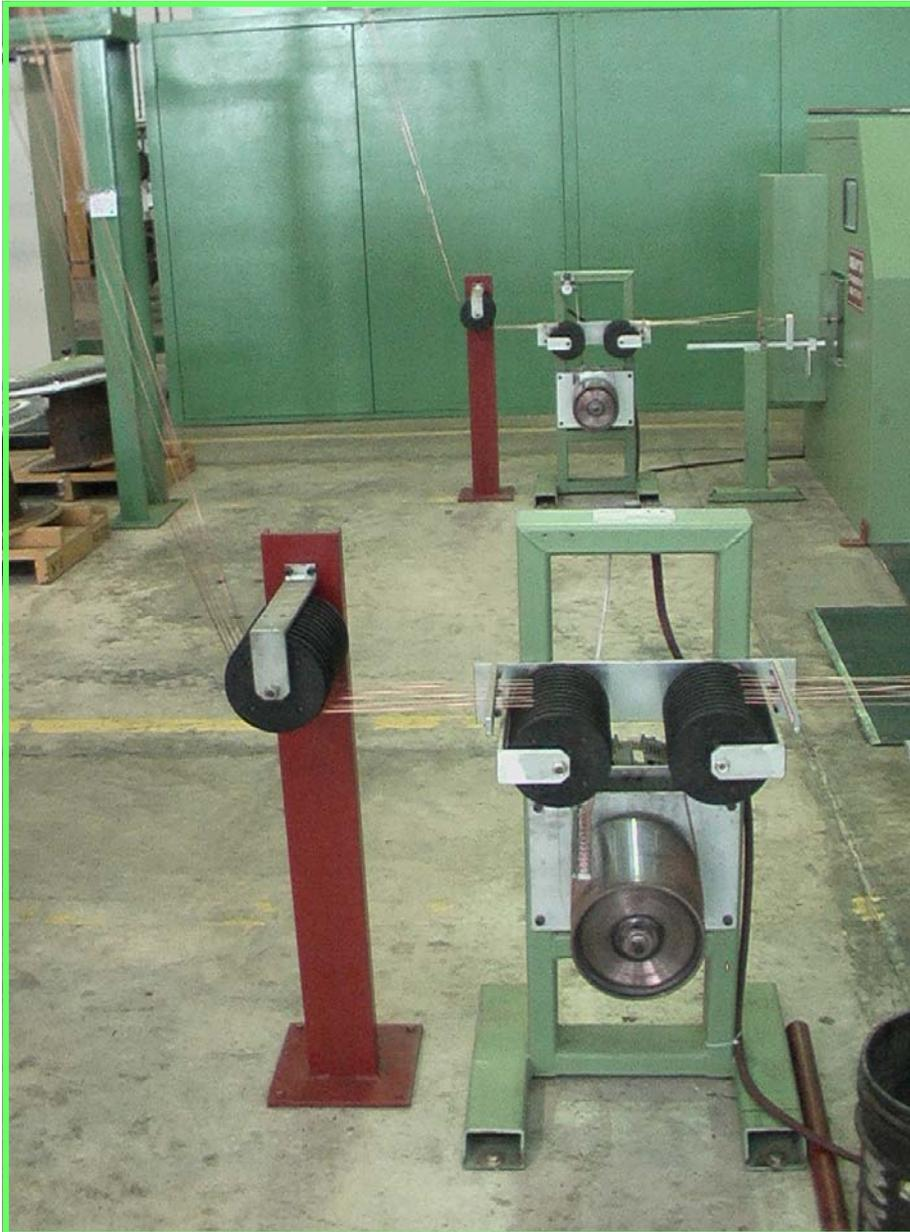
Le cabestan est un dispositif que, mis en ligne à plus fils et câbles en déroulement, permet d'égaliser les tensions entre les produits.
